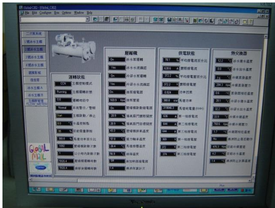
利用空調系統監控運轉資料，加強用電管理。(環球購物)
